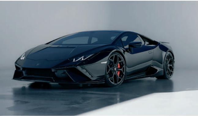
Während die Frontschürze serienmäßig bleibt, wird der serienmäßige Kofferraumdeckel gegen ein Spezialteil von NOVITEC ausgetauscht, das auch in einer Sicht-Carbon-Variante erhältlich ist. Die Schlitze links und rechts leiten die Luft über integrierte Schächte durch die Haube, was dazu beiträgt, die Fahrstabilität bei hohem Tempo weiter zu optimieren.
