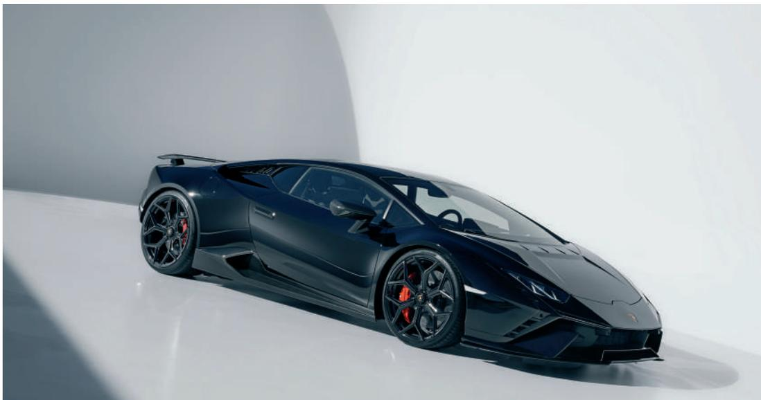
zum Felgenhorn in ein Y auslaufenden Speichen lassen diese Räder noch größer wirken als sie es sowieso schon sind. Auf der Vorderachse werden 9Jx20 Räder mit 245/30 ZR 20 Hochleistungsreifen gefahren. Die 12.5Jx21 Felgen an der Hinterachse sorgen mit 325/25 ZR 21 Pneus für hervorragende Traktion.
